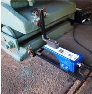
SuessCo Riss-Monitor im Praxiseinsatz, an einem Brückenlager
